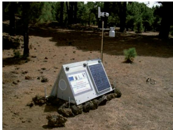
Figura 2. Estación geoquímica EHI01 para medida de flujo de gases. Llanos de Guillén, isla de El Hierro.
