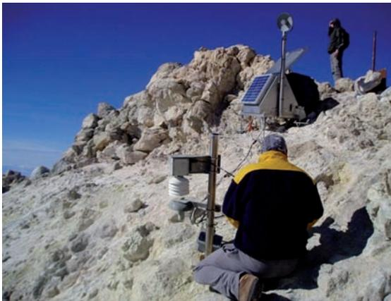
Figura 4. Estación geoquímica para el seguimiento y medida de ratios de los principales componentes de los gases volcánicos emitidos por la actividad fumarólica del Pico del Teide.
