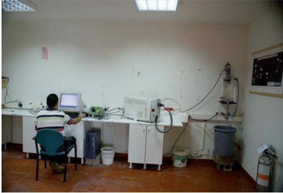
Figura 3. Estación geoquímica TFE03 localizada en la galería San Fernando, Santiago del Teide, Tenerife, para el seguimiento y medida de gases disueltos en aguas subterráneas mediante QMS y espectrómetro alfa.
